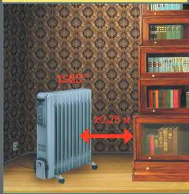
Відстань від приладів електроопалення до горючих матеріалів і будівельних конструкцій має становити не менше 0,25м. Температура зовнішньої поверхні електроопалювальних приладів у найбільш нагрітому місці в нормальному режимі роботи не повинна перевищувати 85°C
